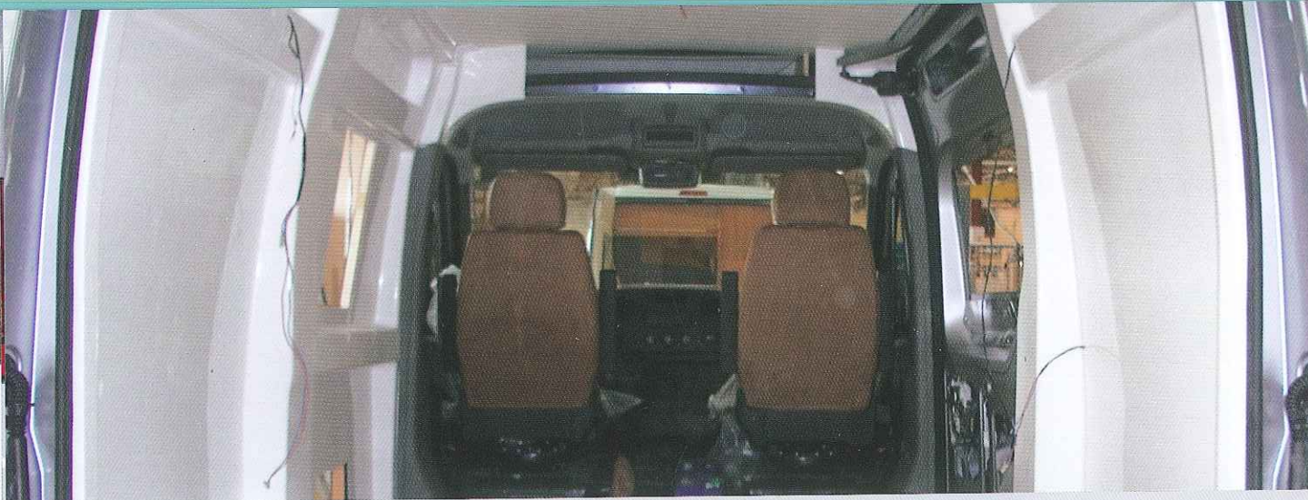
PAROIS MOULÉES À LA CARROSSERIE WALLS MOULDED TO THE BODY
